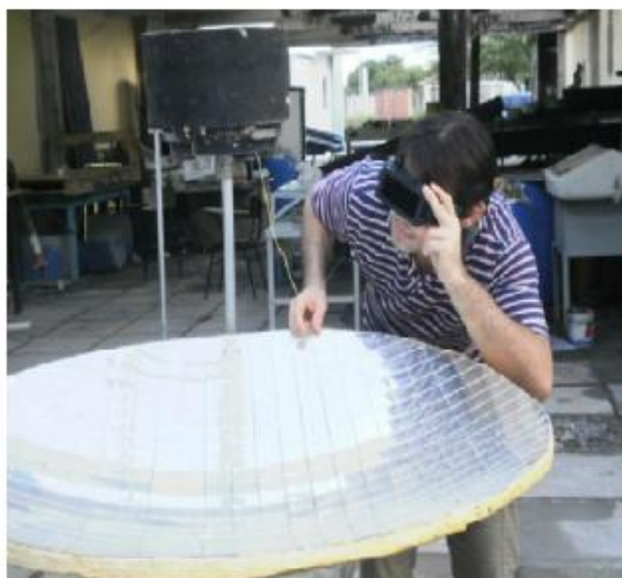
Fig. 6: Protótipo do forno solar parabólico confeccionado por Macedo. Fonte: Macedo, 2011.
