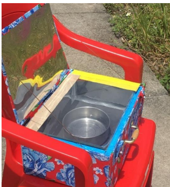
Fig. 4: Protótipo do forno solar confeccionado em funcionamento. Fonte: Autores, 2019.
