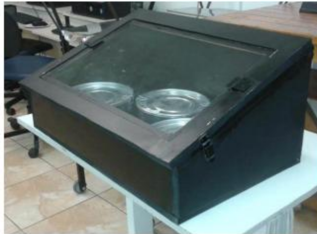
Fig. 5: Protótipo do forno solar confeccionado por Rezende. Fonte: Macedo, 2015.
