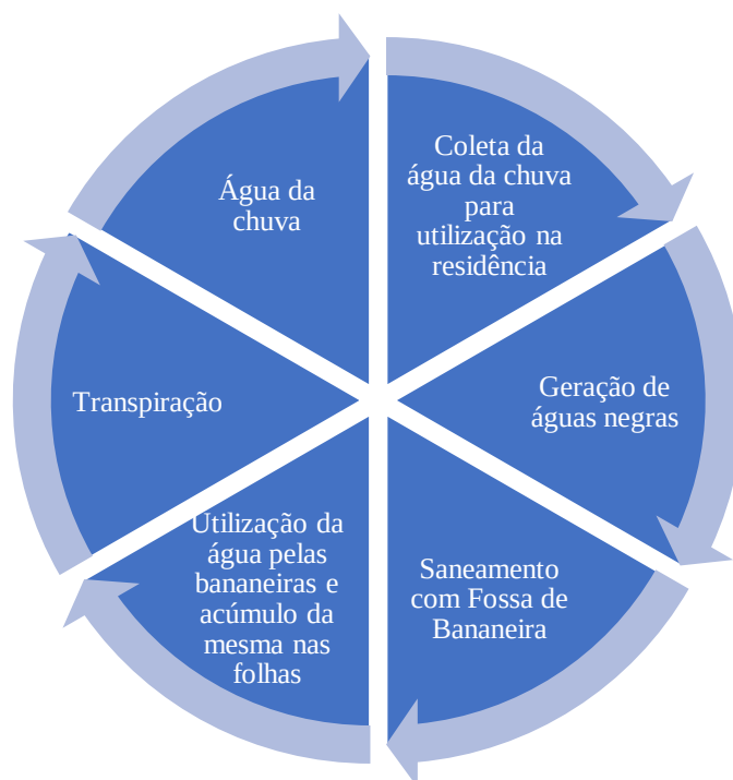
Fig. 1: Fluxograma da água na Fossa de Bananeira FONTE: Próprio autor
